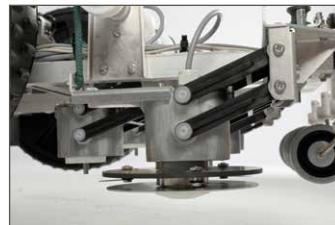
Jeder Belrobotics Mähroboter besitzt mehrere frei schwebende Messerköpfe. Diese passen sich durch eine vertikale Bewegung automatisch der Geländestruktur an.
