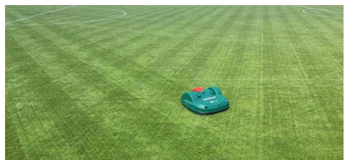
Durch die Musternavigation bei GPS-RTK Mährobotern wird eine Flächenleistung von bis zu 75'000 m<sup>2</sup> erreicht.
