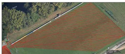
Dank der GPS-RTK Technologie mäht der Roboter in Bahnen. Über das GPS im Roboter und einer GPS-RTK Basisstation wird die Position auf eine Genauigkeit von 2 bis 3 cm bestimmt. Die Roboter variieren die Laufrichtung der Muster, um dauerhafter Spurenbildung vorzubeugen.
