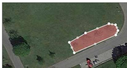
Roboter mit GPS-RTK-Unterstützung erhalten die Möglichkeit hochpräzise GPS-Verbotszonen festzulegen. So können Sie zeitweilig Flächen ausgrenzen um Rasen der saniert wird zu schonen oder um Blumeninseln ausblühen zu lassen.
